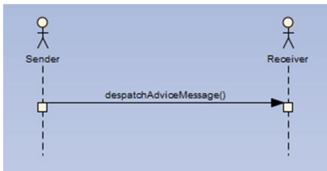
Abbildung 55: Interaktionsdiagramm „Versand einer externen Warenversandnotiz“
